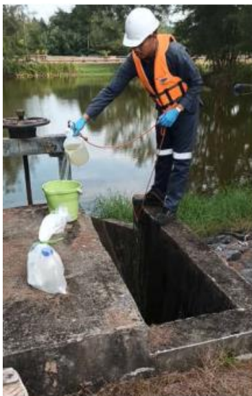
รูปที่ ค-6 การเก็บตัวอย่างตรวจวัดคุณภาพน้ำทิ้ง ของท่าเทียบเรือขนถ่ายน้ำมันเชื้อเพลิงสำหรับโรงไฟฟ้ากระบี่
