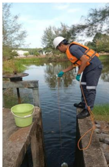
รูปที่ ค-6 การเก็บตัวอย่างตรวจวัดคุณภาพน้ำทิ้ง ของท่าเทียบเรือขนถ่ายน้ำมันเชื้อเพลิงสำหรับโรงไฟฟ้ากระบี่
