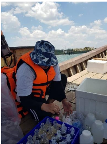
รูปที่ ค-5 การเก็บตัวอย่างตรวจวัดคุณภาพน้ำผิวดิน ของท่าเทียบเรือขนถ่ายน้ำมันเชื้อเพลิงสำหรับโรงไฟฟ้ากระบี่
